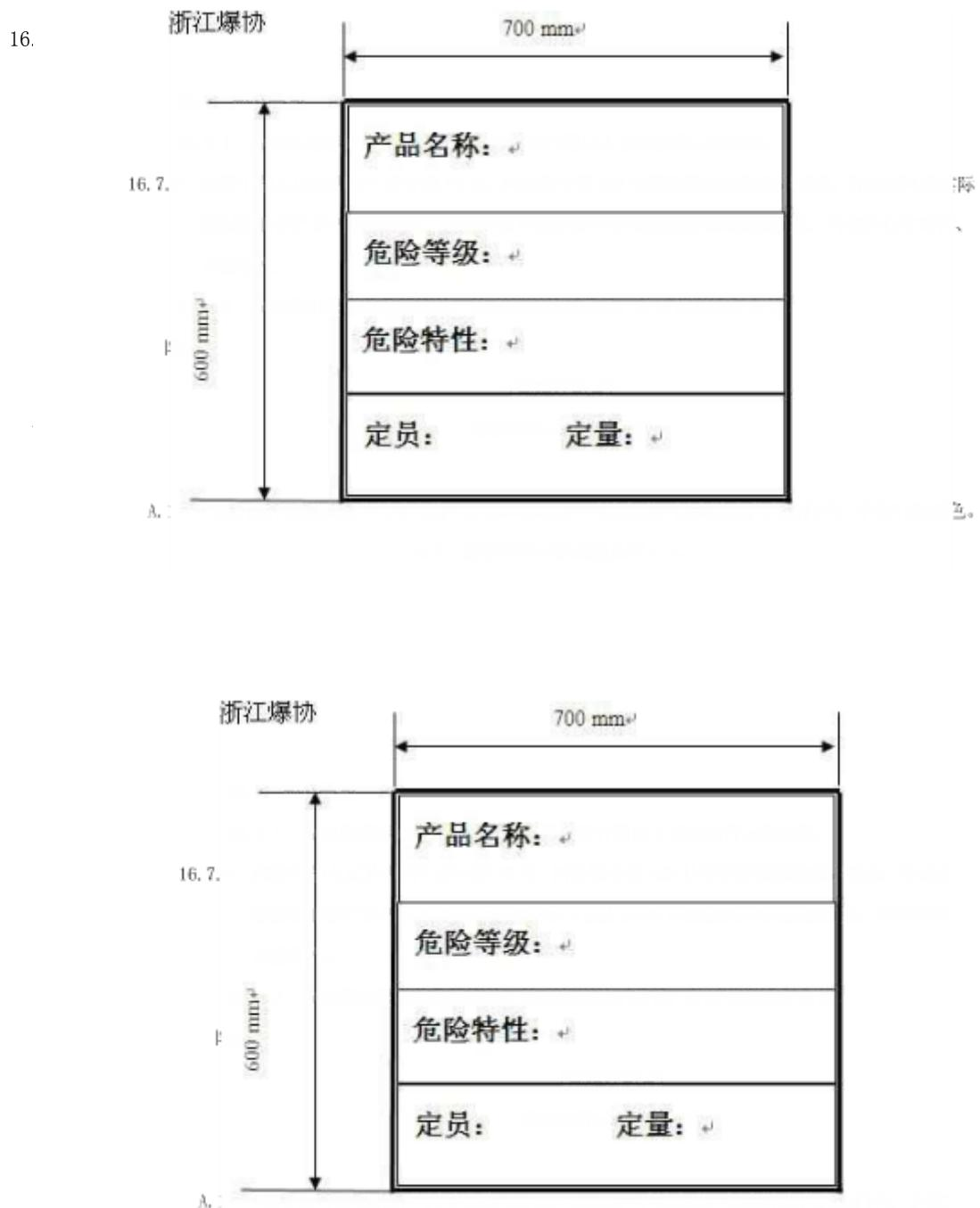
图 A.1 储存库警示标志牌图例
